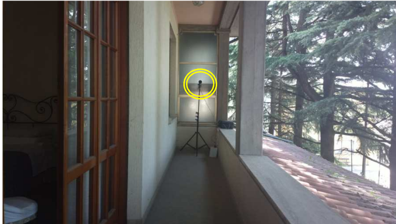
Postazione di rilievo sul terrazzo – misura rappresentativa dei futuri affacci ai livelli secondo e terzo della porzione di edificio in progetto.
